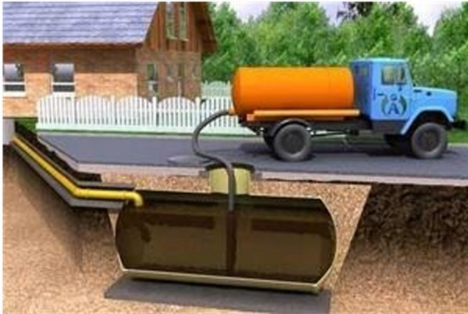
2.3.2. attēls. Izbūvētas notekūdeņu krājvertnes piemērs. 18
