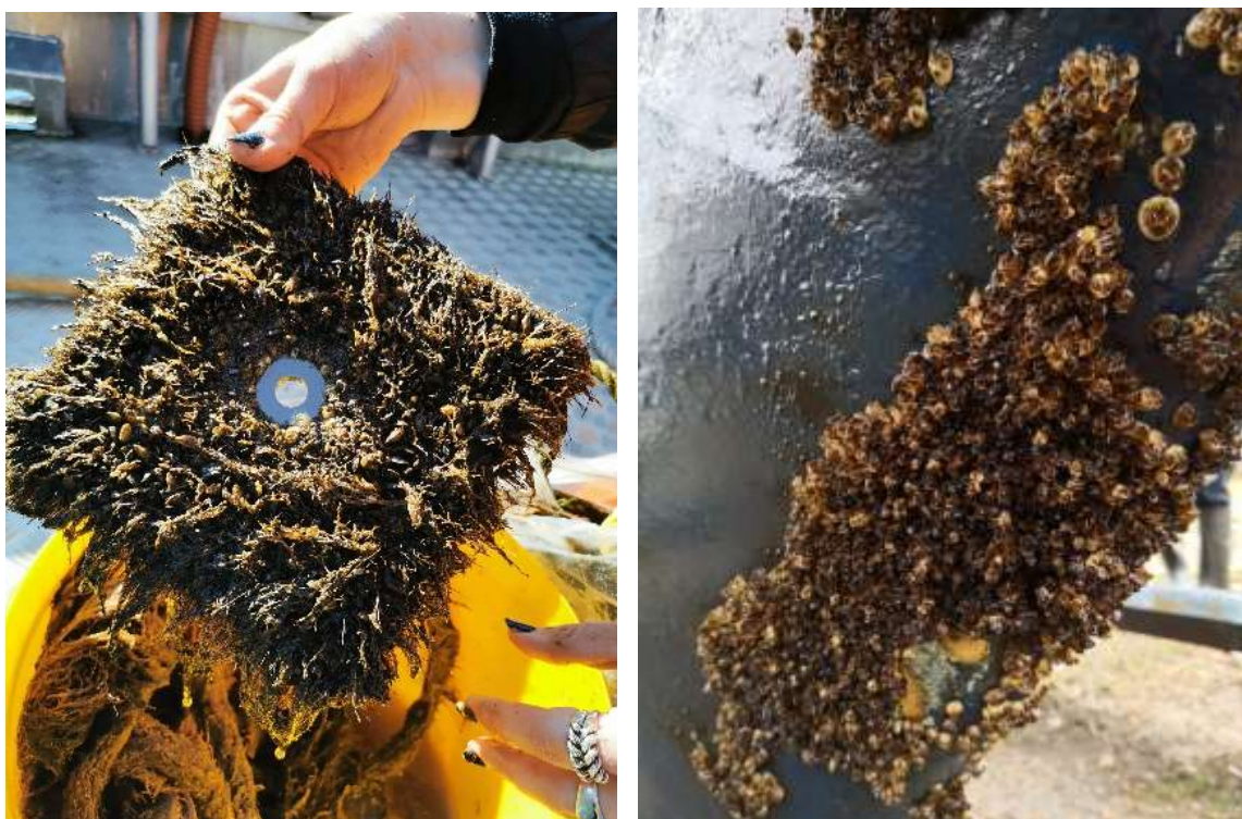
3.3. attēls. Bioloģiskais apaugums uz plātņu konstrukcijas Ventspils ostā un jahtas korpasa pēc kuģošanas sezonas. Foto autore: Māra Kostanda un Solvita Strāķe
