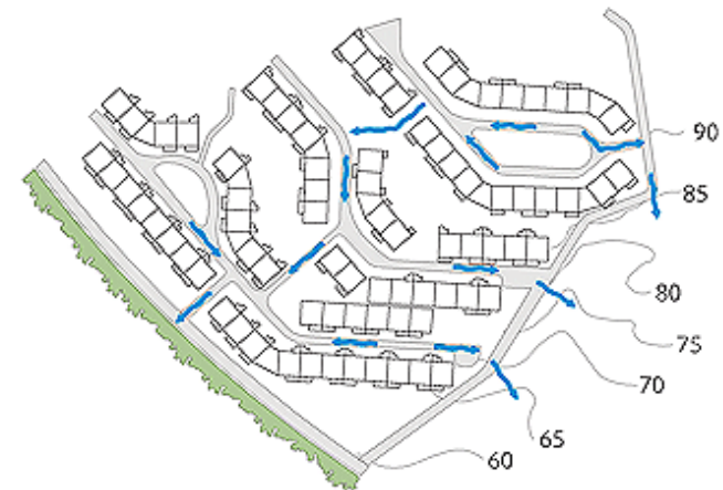
Fig. 64 Eksempel på kart som viser planlagte flomveier i et nytt boligområde Overvannet ledes bort på overflaten slik at det ikke gjør skade.
