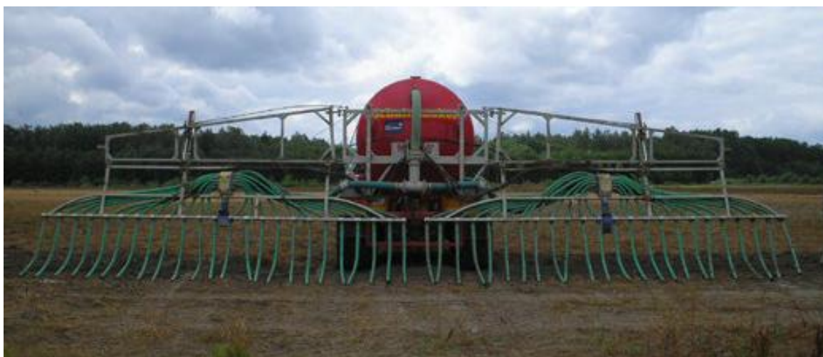
Lentveida izkliedētājs ar nokarenām caurulēm. Avots: GreenAgri projekta rezultāti
